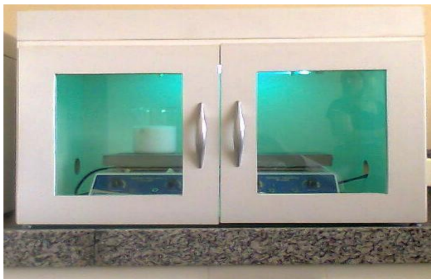
Figura 1 - Sistema experimental composto por câmara fotocatalítica, lâmpadas germicidas e agitador mecânico
