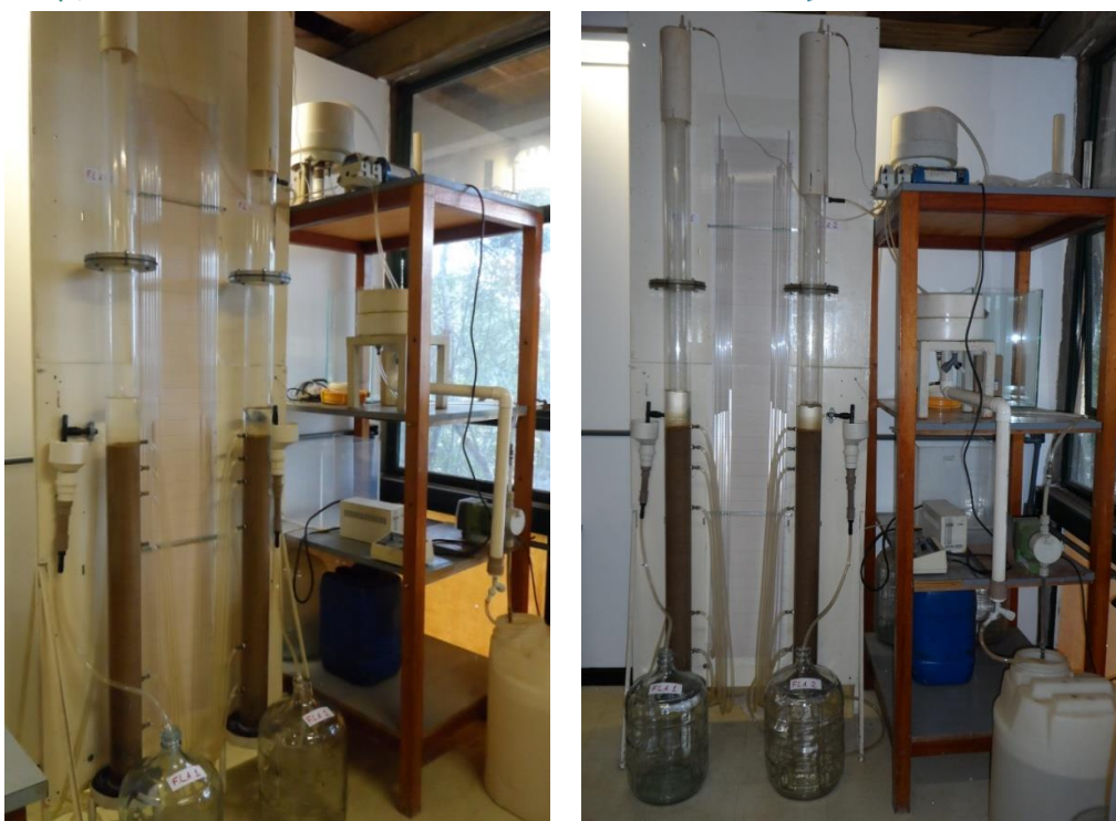
Figura 2 – Instalação Piloto de filtração lenta.
