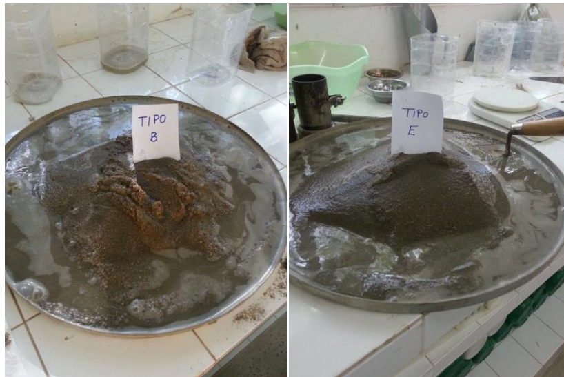
Figura 1: Tipo (B) com o Fator A/C 3; Tipo (E) com o Fator A/C 2,5
