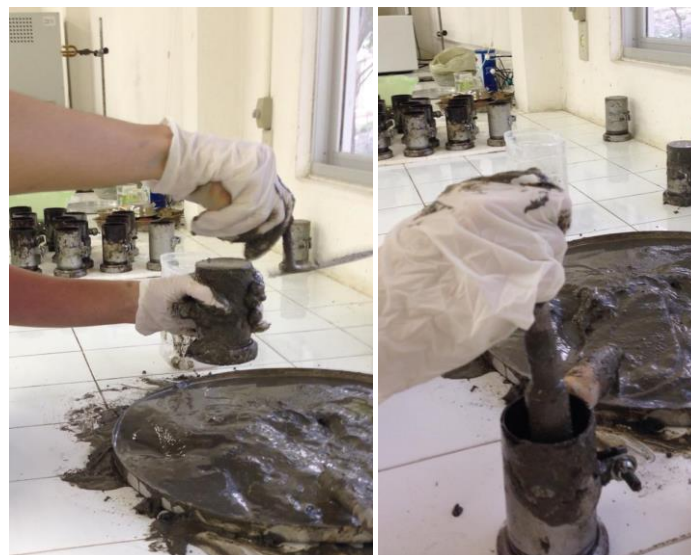
Figura 2: Confecção dos corpos de prova
