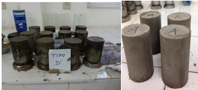
Figura 3: Corpos de prova moldados e desmoldados
