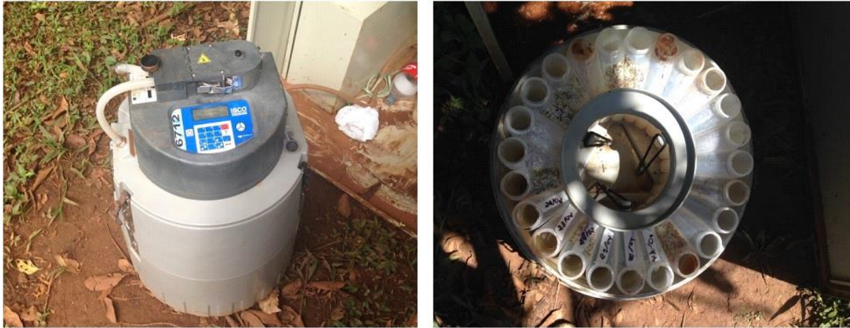
Figura 3. Amostrador automatizado de coleta de sedimentos.
