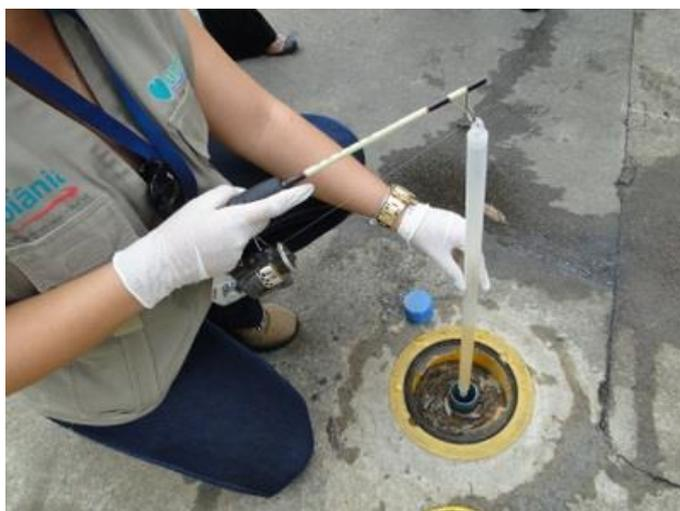
Figura 1 – Um dos *bailers* utilizados na obtenção das amostras.
