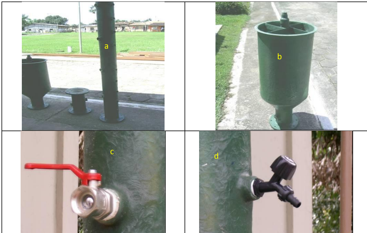
Figura 2. Fotografias do reator híbrido anaeróbio-aeróbio. a) Módulo de para conexão da bomba de alimentação e de recirculação; e de zona de reação; b) Decantador, c) ponto de amostragem para biopartícula ou de recirculação e d) ponto de amostragem líquida para perfis ao longo da altura.
