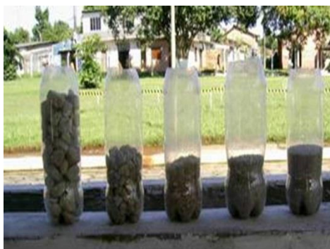
Figura 4. Ilustração da camada suporte do reator.
