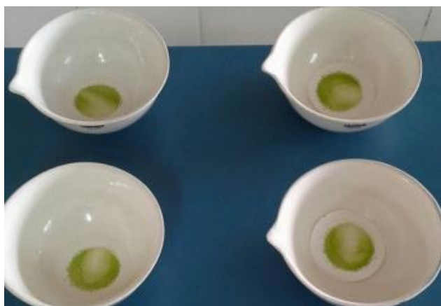
Figura 2 – Membranas de acetato de celulose com biomassa da microalga Scenedesmus sp
